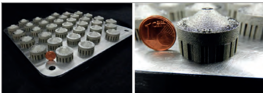
5. PIASTRA CON GLI UGELLI PRODOTTI SLM (A SINISTRA) E DETTAGLIO SU UN SINGOLO UGELLO (DESTRA). SI POSSONO CHIARAMENTE OSSERVARE LE STRUTTURE DI SUPPORTO ALLE PARTI.
