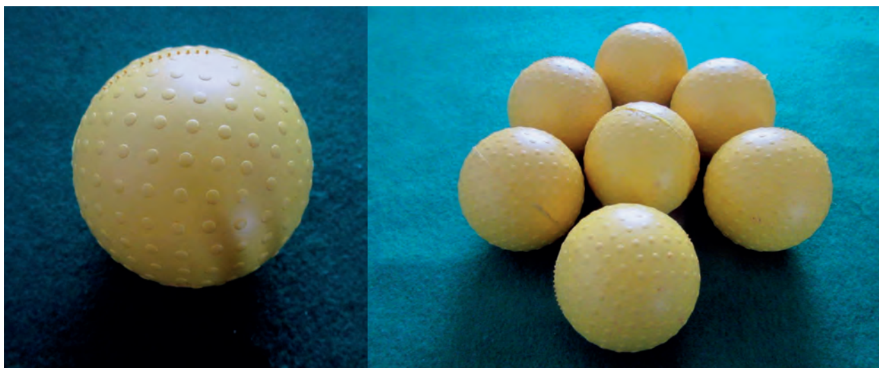
16. Palline da golf risultanti da impronte lavorate con il sistema cartesiano.
