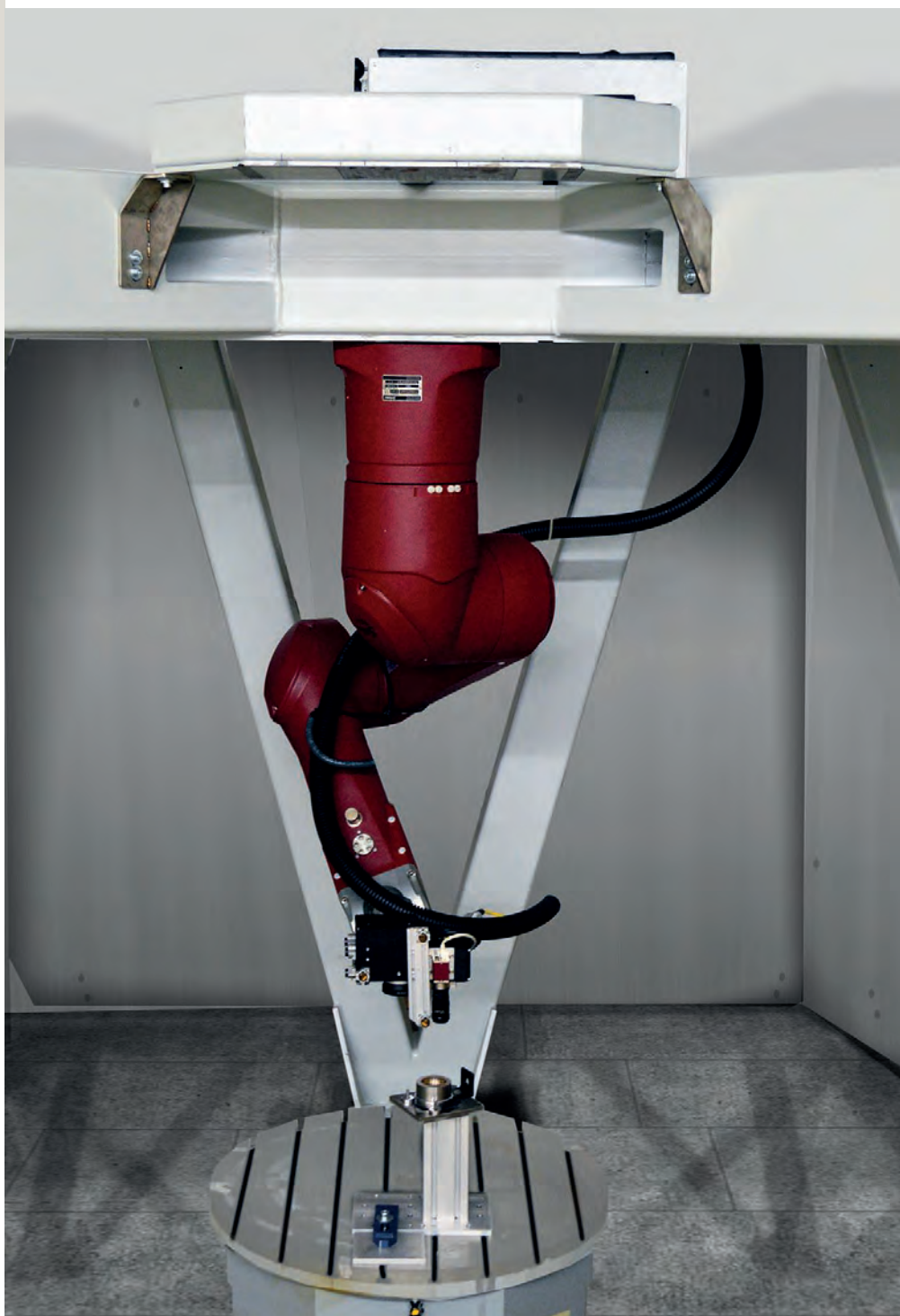
3. Dimostratore INFINITE al lavoro la texturizzazione di un tassello per stampi semisferico.
