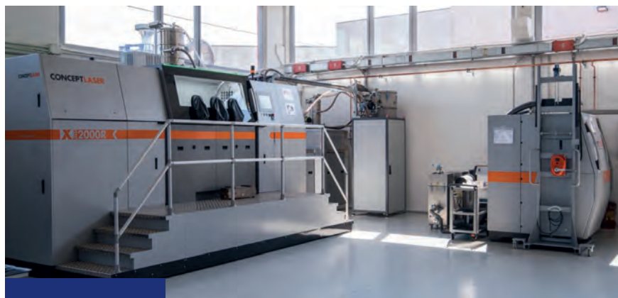
LA PIÙ GRANDE MACCHINA LASERCUSING DI ZARE: X LINE 2000R. PER GENTILE CONCESSIONE DELLA ZARE
